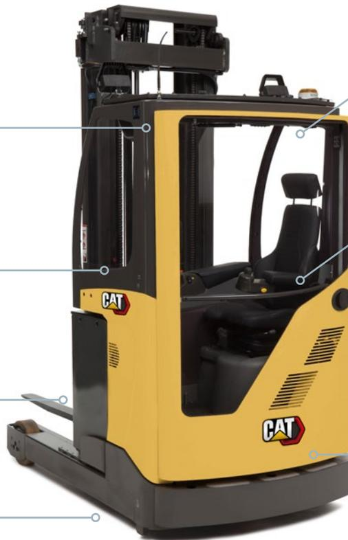
Bei Ausrüstung mit den erforderlichen Kabinen- und Kaltlagermodifikationen (MODCS) kann ein Schubmaststapler zuverlässig bei Temperaturen unter dem Gefrierpunkt bis  $-35\text{ }^{\circ}\text{C}$  eingesetzt werden.
