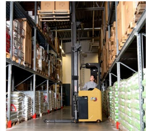
Dépourvus de plates-formes et de barres latérales rabattables, qui nécessitent de s'arrêter, les gerbeurs à conducteur porté assis sont plus rapides et plus compacts que les chariots à plate-forme. En termes de levage, ils n'ont rien à envier aux chariots à mât rétractable. Ils sont également moins chers, et peuvent fonctionner dans les espaces restreints. Alors, pourquoi ne pas rétrécir les allées, surélever les rayonnages et mieux exploiter l'espace de l'entrepôt ?
