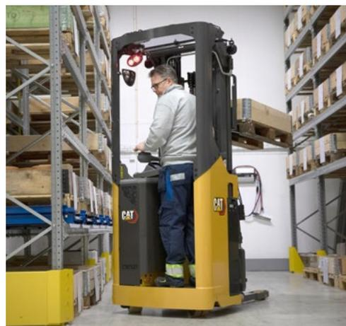
Les gerbeurs à conducteur porté debout vous permettent d'utiliser au maximum votre précieuse surface d'entreposage, avec des allées plus étroites et des étagères plus hautes. Accomplissant de nombreuses tâches, dont la préparation de commandes, ils offrent des capacités de levage similaires à celles de nombreux chariots à mât rétractable, pour un coût plus faible et dans des espaces plus restreints.
