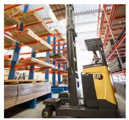
Le réglage automatique de la vitesse de conduite et celle des composants hydrauliques en fonction de l'angle de braquage, de la hauteur de levée et du poids de la charge garantit un fonctionnement sûr, rapide et en douceur. Selon le modèle de mât inclinable employé, le contrôle de stabilité du mât est standard ou optionnel.
