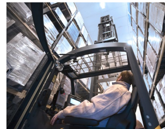
En option, la cabine peut recevoir un toit de protection transparent muni d'une grille métallique.
