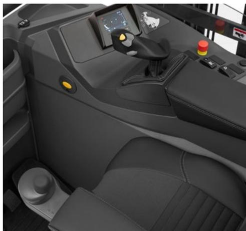
Pour un confort accru et une position de conduite sur mesure, les accoudoirs et la hauteur du plancher du chariot sont réglables. La fonction *Palm Steering* et le joystick multifonction offrent une position détendue sans sacrifier la précision, tandis qu'un siège inclinable soulage la contrainte de surveiller les charges en hauteur.
