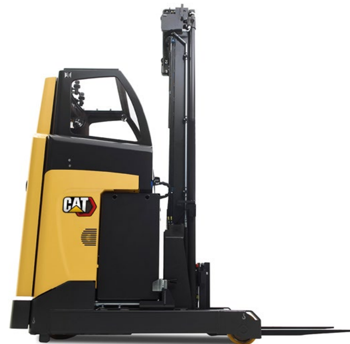
Lämmitettävä ohjaamo, varustettu valinnaisella suipentuvalla turvakatolla.
