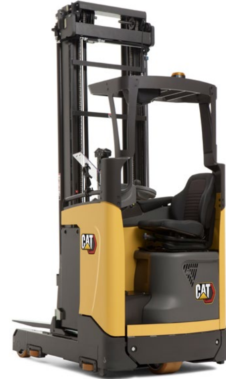
Kuvassa malli NR14N3C valinnaisella suipentuvalla turvakatolla ja kisko-ohjauksella varustettuna.
