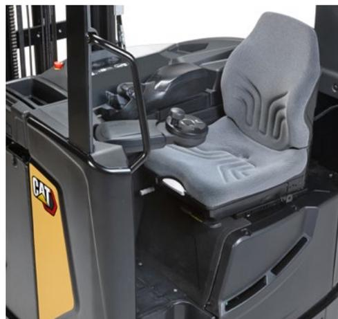
Prostorná kabina je vybavena vysoce komfortním sedadlem **Grammer**, polstrovanými stěnami a úložnými funkcemi. Inovativní prvky pro ovládání hydraulického systému **finger tips** jsou zabudovány do ergonomické nastavitelné loketní opěrky. Řidiči mohou nastavitelný volant ovládat rukama v různých polohách.
