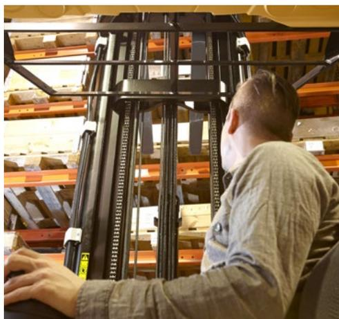
Zdvihací zařízení **powerRamic** je díky hydraulickým válcům zabudovaným do jeho profilu pevnější, užší a nabízí oproti běžným konstrukcím lepší viditelnost. **Responsive Drive System (RDS)** umožňuje plynulé a přesné ovládání všech pohybů vozíku a jeho sestavy zdvihacího zařízení.
