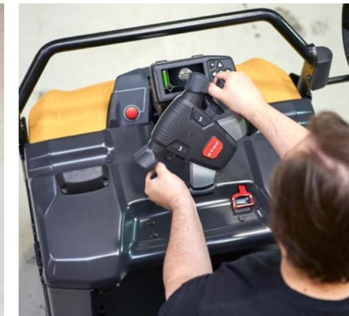
Ova snažna vučna vozila kapaciteta 3,0 i robusni kapacitet 5,0 nude pametnu tehnologiju izgrađenu na Cat® Responsive Drive System (RDS). Prilagodljivo upravljanje, inteligentna kontrola skretanja i automatska optimizacija vuče, ubrzanja i kočenja osiguravaju preciznu, sigurnu i ugodnu vožnju.
