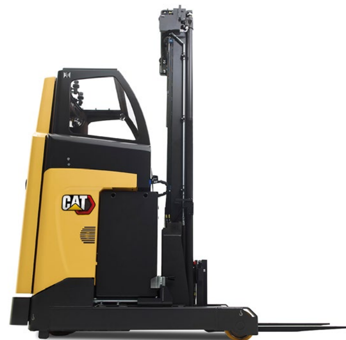
Grijana kabina s kupolastom zaštitom iznad glave u opciji.
