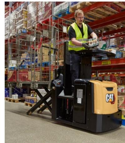
Като надграждат технологията на реактивната система за задвижване (Responsive Drive System, RDS), въведена за първи път в съвременните електрокари, сортировачите реагират бързо на поведението на оператора при управлението, както и на скоростта на движение.
