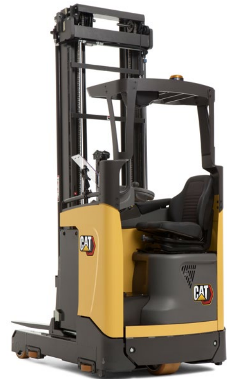
NR14N3C, показан с опции за коничен протектор над главата и управление с направляващи релси.
