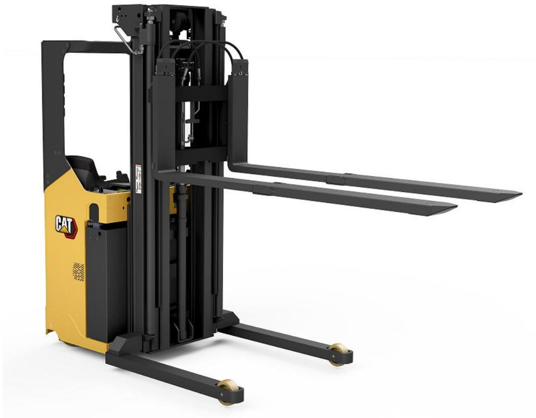
(Didascalìa) Da ogni corsia, le forche telescopiche raggiungono le scaffalature per impilare e prelevare i carichi a due profondità di pallet.
