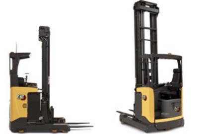
Electrostivuitoare cu catarg retractabil: capacitate 1,2 – 2,5 tone
