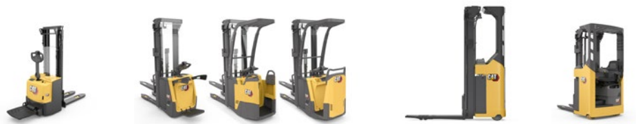
Elektromos magas emelésű gyalogkísérető targoncák: 1.0 – 2.0 tonna teherbírás
