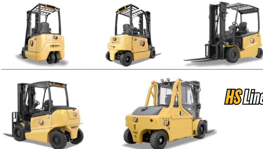
Elektromos homlokvillás targoncák: 1.4 – 12.0 tonna teherbírás
