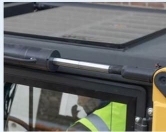
Los cilindros de inclinación del mástil en posición elevada refuerzan la estabilidad, especialmente al trabajar en altura, y la capacidad de elevación residual.
