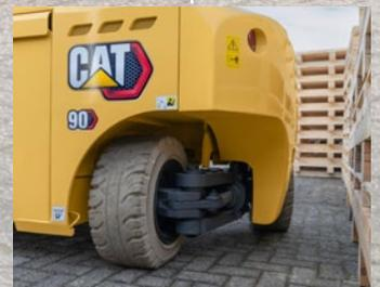
El eje de dirección trasero de más de 100° permite a la carretilla girar sobre sí misma sin cambiar de lugar y realizar giros laterales al instante sin necesidad de un movimiento de retroceso inicial.
