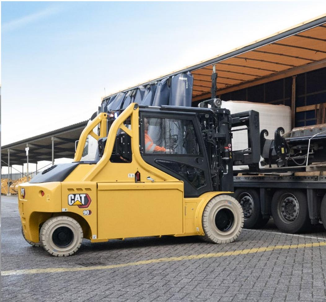
Los avanzados controladores de tracción y de la bomba hidráulica garantizan la suavidad y la precisión en todos los movimientos de tracción, mástil y horquilla.
