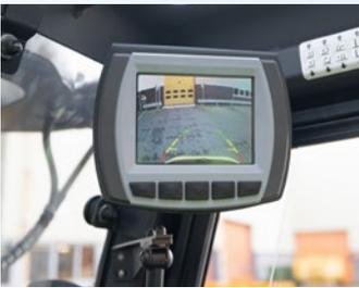
La cámara de visión posterior (instalada de serie), combinada con los diseños especiales del mástil, el salpicadero y la protección superior, permite obtener una visibilidad despejada en todas las direcciones, sin que el operador tenga que inclinarse ni cambiar de posición.
