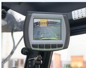
La telecamera posteriore (di serie) si combina con un design speciale del montante, del pannello di controllo e del tettuccio di protezione per offrire una visuale libera a 360°, senza che sia necessario sporgersi o cambiare posizione.
