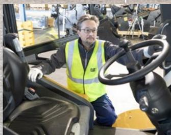
La facilità di accesso alla cabina, con salita ridotta, è ideale per gli operatori che scendono e risalgono frequentemente.
