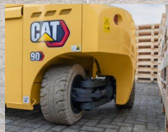
L'asse posteriore sterzante a 100 e più gradi permette al carrello di ruotare su se stesso, all'interno delle proprie dimensioni, e di effettuare istantaneamente virate laterali senza bisogno di un movimento iniziale all'indietro.
