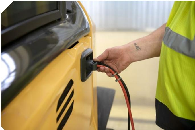
Per la maggior parte dei carrelli elevatori elettrici controbilanciati Cat è possibile scegliere tra le batterie al piombo-acido e quelle agli ioni di litio (Li-ion) completamente integrate. Tecnologia Li-ion:
