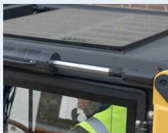
I cilindri di inclinazione del montante, posizionati in alto, migliorano la stabilità, soprattutto ad altezze maggiori, e aumentano la capacità residua.
