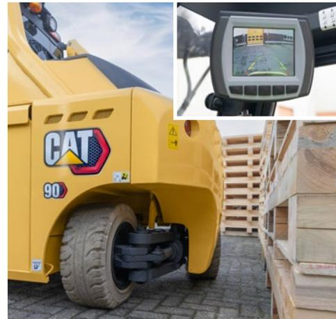
Kompakte Abmessungen und hohe Lenkeinschläge - einschließlich +100° Lenkachseinschlag bei den NH-Modellen - ermöglichen eine hervorragende Manövrierfähigkeit. Ein niedriges Schuttdach, das optional für alle Staplertragfähigkeiten erhältlich ist, ermöglicht das Einfahren in Container. Sicheres und präzises Manövrieren wird durch das Freisichtdesign und eine Rückfahrkamera unterstützt.
