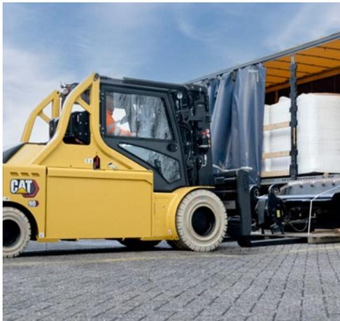
Leistungsstarke Batterien und energieeffiziente elektrische Systeme bieten eine ideale Mischung aus Leistung und Laufzeit. Die Batterien sind in zwei Teile geteilt, so dass sie mit einem Niederhubwagen oder einem anderen Gabelstapler leicht ausgetauscht werden können. Der geringe Wartungsaufwand und die Langlebigkeit der Frontstapler in rauen Umgebungen reduzieren die laufenden Kosten und Ausfallzeiten weiter.
