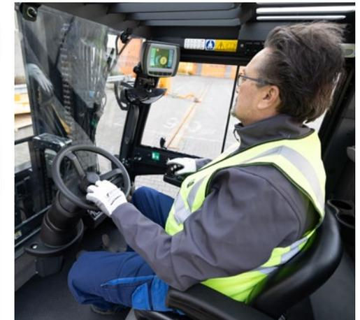
Eine niedrige Sitzposition bedeutet weniger Kletterei für Fahrer, die häufig die Kabine verlassen und wieder einsteigen. Die geräumige, komfortable und ergonomische Fahrerkabine ist gummigelagert, um Vibrationen und Lärm zu minimieren. Hydraulikpumpen, Antriebseinheiten und Steuerungen sind ebenfalls für leisen Betrieb, Komfort und geringe Belastung ausgelegt.
