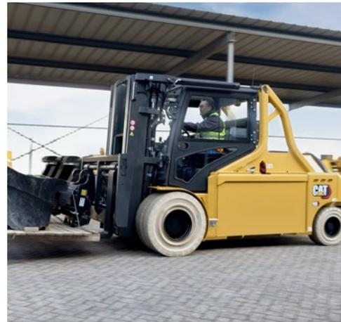
Die fortschrittliche elektrische Antriebs- und Hubmotortechnologie gibt Ihnen die Kraft und Geschwindigkeit, die Sie sich wünschen. Hohes Drehmoment, starke Beschleunigung und viel Hubkraft werden mit präziser elektronischer Steuerung und Leichtgängigkeit bei allen Aktionen kombiniert. Hoch angeordnete Hubgerüstkippzylinder verbessern die Stabilität und die Resttragfähigkeit.
