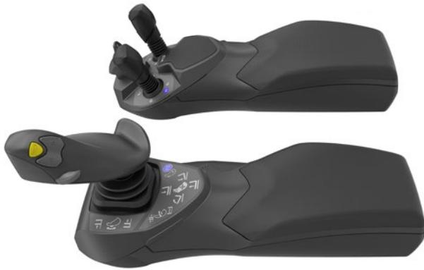
Die Dual-Joystick-Option trennt Funktionen wie das Öffnen der Klammer, um versehentliche Bewegungen zu vermeiden. Sie ist besonders nützlich für Fahrer, denen die Fingerhebel zu klein sind, um sie mit Handschuhen (oder großen Händen) zu bedienen.
