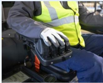
Hydraulische Bedienelemente mit Fingertipp auf einer bequemen, verstell-baren Armlehne sind bei den NH-Modellen Standard und bei den N-Modellen optional.
