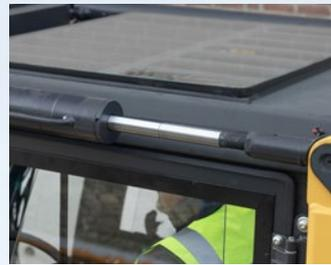
Hoch angeordnete Hubgerüstneigezylinder verbessern die Stabilität, insbesondere in größeren Höhen, und erhöhen die Resttragfähigkeit.
