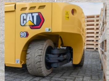
Die hintere +100°-Lenkachse ermöglicht es dem Stapler, auf der Stelle und innerhalb seiner eigenen Abmessungen zu wenden und sofortige seitliche Wendemanöver durchzuführen, ohne dass eine Rückwärtsbewegung erforderlich ist.
