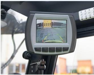
Die Rückfahrkamera (serienmäßig) sorgt in Kombination mit einem speziellen Design des Hubgerüsts, des Armaturenbretts und des Schutzdachs für eine klare Rundumsicht, ohne dass sich der Fahrer bücken oder seine Position verändern muss.
