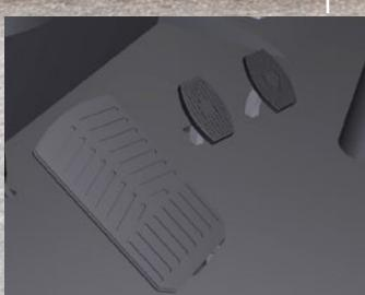
Oddělené pedály pro jízdu vpřed a vzad umožňují rychlé změny směru jízdy v rušných provozech a jsou doplněny velkým brzdovým pedálem pro rychlé použití bez větší námahy. (Sada konvenčních pedálů je volitelná.)
