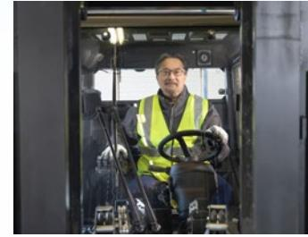
Konstrukce stožáru s výhledem bez překážek zahrnuje usazení triplexního stupně do duplexního a rozdělení válců volného zdvihu na dvě části.
