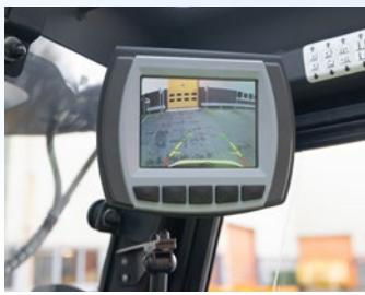
Zadní kamera (standardní výbava) v kombinaci se speciální konstrukcí stožáru, přístrojové desky a ochranného rámu kabiny poskytuje jasný výhled do všech stran, aniž by se řidič musel naklánět nebo měnit polohu.
