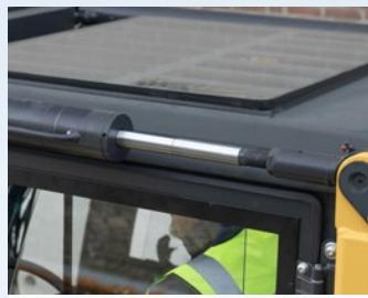
Vysoko umístěné válce naklápení stožáru zvyšují stabilitu, zejména ve větších výškách, a zvyšují zbytkovou zvedací kapacitu.
