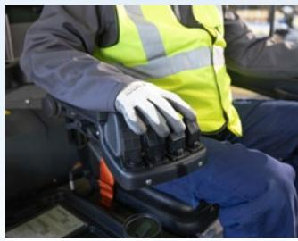
Tlačítkové ovládání hydrauliky na pohodlné, nastavitelné opěrce na ruce je standardem u modelů NH a volitelným příslušenstvím u modelů N.
