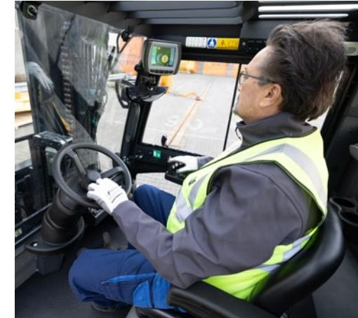
Zahvaljujući baterijama visokog kapaciteta te energetski učinkovitim električnim sustavima, ovi modeli idealan su spoj performansi i rada bez zastoja. Baterije su podijeljene u dva dijela radi lakše bočne zamjene s pomoću paletnog ili sličnog viličara. Mala potreba za održavanjem viličara te njegova izdržljivost u zahtjevnim okruženjima dodatno smanjuju tekuće troškove i zastoje u radu.
