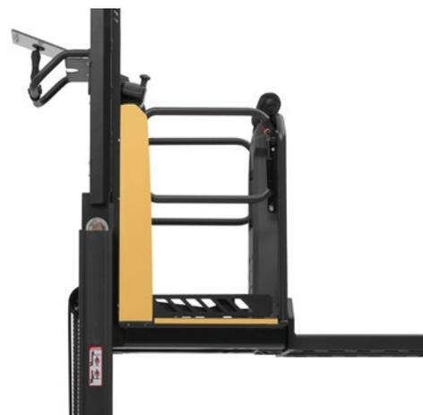
El sistema de puertas laterales LiftComfort y SecurGate se ofrece de serie en la plataforma de 1,8 m y es opcional en la plataforma de 1,2 m. El contenedor de recogida se eleva a la altura conveniente. Si las puertas están abiertas a más de 1,2 m se desactiva el funcionamiento de la carretilla.
