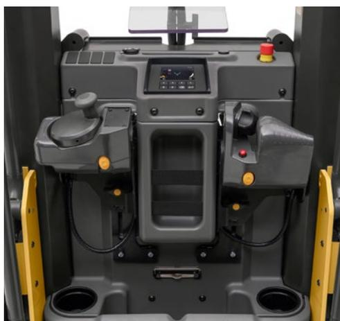
La última interfaz de usuario más reciente permite que el conductor coloque su mano derecha sobre una unidad de control adaptada de manera anatómica que tiene posición ajustable. Además de controlar con precisión las funciones de la carretilla, permite apoyar la mano de manera firme y cómoda, dejando al conductor que maneje el volante Midi con la mano izquierda.
