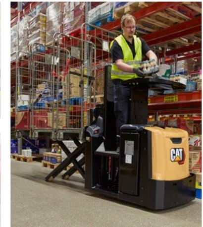
Estos recogepedidos incluyen la tecnología del sistema RDS (Responsive Drive System), incorporada como tecnología pionera a las carretillas contrapesadas eléctricas Cat® más recientes, reaccionando rápidamente a la velocidad de desplazamiento y a las maniobras de dirección del operador.
