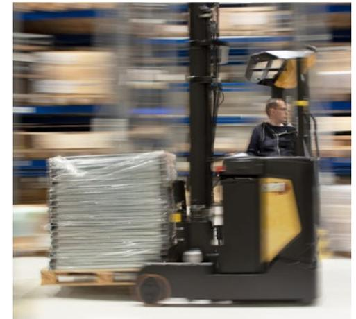
La velocidad de conducción se controla de manera suave y automática durante los giros o cuando las horquillas están levantadas para evitar comportamientos de riesgo en el conductor. Otra medida de seguridad es la reducción gradual de la respuesta de la dirección a velocidades crecientes de desplazamiento que permite maniobrar de forma segura.
