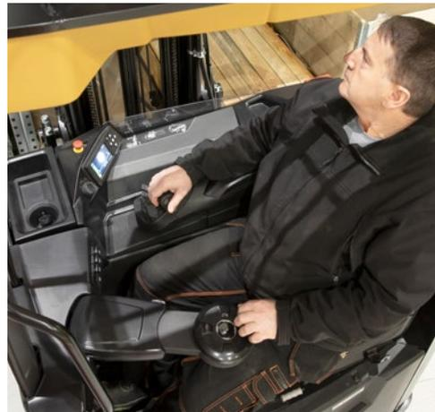
En el reposabrazos ergonómico ajustable se han incorporado controles hidráulicos táctiles avanzados. Se puede ajustar el ángulo y la altura del volante y el conductor puede conducir con distintas posiciones de la mano. Una pantalla multifunción con lecturas en color de gran visibilidad ofrece información útil.
