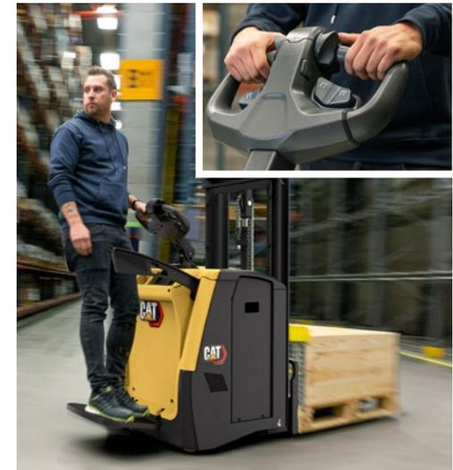
La manipulación doble se consigue colocando la carga de un palet en el caballete y otra en las horquillas. Con esta disposición, la carretilla se mantiene compacta y es muy maniobrable incluso en espacios reducidos.
