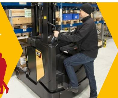
La gama N2 es la ideal para los conductores que tienen que subirse y bajarse continuamente de la carretilla, gracias en parte al peldaño más bajo y a la altura del asiento. Además, su sistema de dirección ajustable puede levantarse fácilmente para subirse y bajarse del equipo sin obstáculos y regresar rápidamente a la posición deseada. También ofrece altos niveles de ergonomía y confort.
