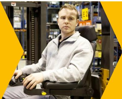
La gama N3 ofrece lo máximo en cuanto a confort y ergonomía a los conductores que pasan gran parte del día sentados en la carretilla. Las funciones incluyen: *Palm Steering* y joystick multifuncional, en reposabrazos ajustables, para una posición de conducción relajada y total control con el mínimo movimiento; asiento basculante para minimizar la tensión al observar las cargas en altura; altura de suelo ajustable eléctricamente para adaptarse al peso y a la altura del conductor.\*
