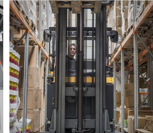
Nu este nevoie de stivuitoare de încărcare sau stații P&D (prelevare și depozitare) la capătul culoarelor, deoarece modele noastre VNA cu operator așezat au grija de transport, dar și de stivuire și de-stivuire. Astfel se poate reduce dimensiunea flotei, numărul de șoferi și timpul, odată cu creșterea spațiului de depozitare.
