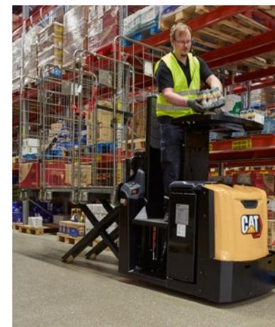
Com base na tecnologia “Responsive Drive System” (RDS) introduzida pela primeira vez em empilhadores elétricos contrapesados Cat, os order pickers reagem rapidamente às manobras do volante e à velocidade de translação.
