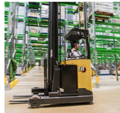
Para um ajuste confortável e personalizado, os apoios de braços do empilhador e a altura do piso são ajustáveis. A opção *Palm Steering* e um joystick multifuncional permitem uma condução descontraída, mas precisa, e o banco basculante reduz o esforço ao olhar para as cargas em altura.
