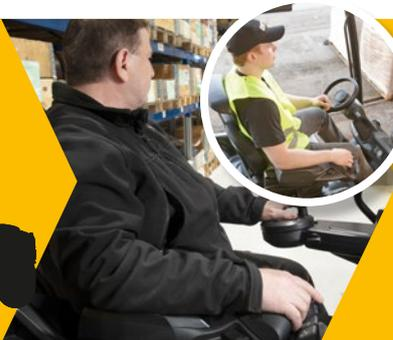
Os controlos e visores da gama N2 são muito semelhantes aos dos empilhadores Cat contrabalançados. Incluem um volante de direção convencional e uma unidade de controlo hidráulica montada no apoio de braço. Esta configuração familiar é importante se o condutor operar empilhadores retráteis também empilhadores contrabalançados.
