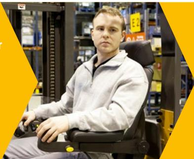
A gama N3 proporciona o máximo conforto e ergonomia para os condutores que passam longos períodos de tempo sentados no banco do condutor ao longo do dia. As funcionalidade incluem: Palm Steering e joystick multifuncional nos apoios de braços ajustáveis para uma posição de condução descontraída e controlo com o mínimo de movimento; banco inclinável para minimizar o esforço ao observar as cargas posicionadas em altura; altura do piso eletricamente ajustável para adaptação ao condutor.\*
