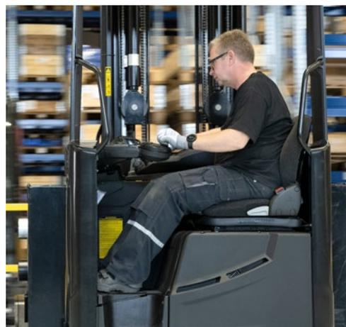
La spaziosa cabina di guida è arredata con un sedile Grammer molto confortevole, pareti rivestite e comodi ripostigli. I moderni comandi idraulici a sfioramento sono incorporati nel bracciolo ergonomico e regolabile. I conduttori possono azionare il volante registrabile adottando svariate posizioni della mano.
