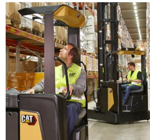
Grazie ai cilindri idraulici incorporati nel suo profilo, il montante poweRamic è più stretto, robusto ed offre una migliore visibilità rispetto ai modelli convenzionali. Tutti i movimenti del carrello e del gruppo montante sono controllati in modo fluido ed accurato grazie al sistema di guida sensibile (Responsive Drive System - RDS).
