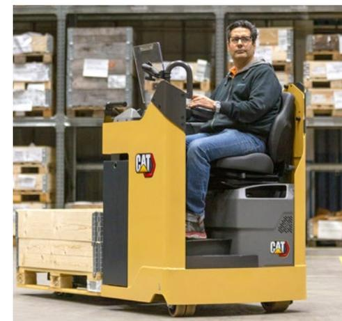
Lo stress, la tensione e l'affaticamento del conducente sono ridotti al minimo grazie a una cabina di guida silenziosa, con basse vibrazioni ed ergonomicamente attrezzata. Progettata per il massimo comfort durante tutta la giornata, offre un'entrata e un'uscita agevoli, molto spazio e un sedile a sospensione regolabile. Tra gli extra lussi opzionali vi è la regolazione elettrica dell'altezza del pavimento per un adattamento perfetto.
