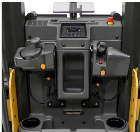
Neueste Bedienerschnittstelle platziert die rechte Hand des Fahrers auf einer anatomisch idealen, lageverstellbaren Bedieneinheit. Neben der präzisen Steuerung der Staplerfunktionen stützt sie diese Hand fest und komfortabel, sodass mit der linken das Midi-Lenkrad bedient werden kann.
