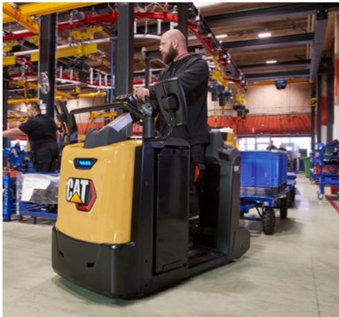
Die leistungsfähigen, robusten Kommissionierer mit 3,0 bzw. 5,0 Tonnen sind mit intelligenten Technologien ausgestattet, die auf dem Cat® Responsive Drive System (RDS) aufbauen. Adaptive Lenkung, intelligente Kurvensteuerung und automatische Traktionsoptimierung, Beschleunigung und Bremsen sorgen für sanfte, präzise, sichere und angenehme Fahrt.
