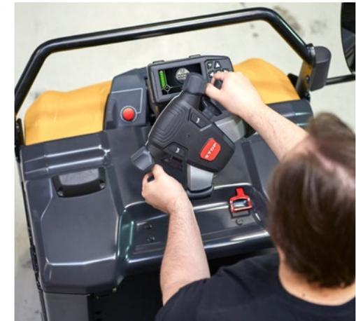
In das innovative Lenkrad sind ergonomisch geformte Bedienelemente integriert, die leicht zu erreichen sind, ohne den Griff loslassen zu müssen. Die vibrationsgedämpfte Lenkeinheit lässt sich mühelos mit einer Hand bedienen und ist auf die perfekte Höhe und den perfekten Winkel einstellbar.
