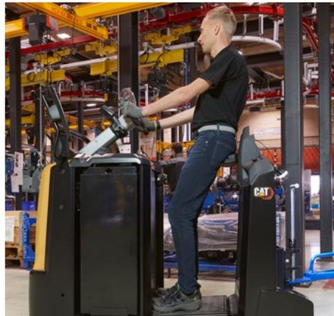
Für besten Komfort, geringe Ermüdung und optimale Zeitnutzung hat der geräumige Bedienplatz eine geringe Einstiegshöhe für leichtes Durchgehen und Ein-/Aussteigen. Der Boden mit Vibrationsdämpfung, die Dreifachfederung und eine bequeme Rückenlehne sorgen für zusätzlichen Komfort.
