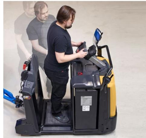
Beim Manövrieren zum Ein- und Auskuppeln ist die „Walk-Beside-Option“ mit Bedienung von außen besonders praktisch, da sie einen direkten Blick auf den Anhänger ermöglicht. Das erleichtert gleichzeitig kurze Maschinenbewegungen. Mit der Funktion „fliegender Start“ kann der Bediener die Maschine vor dem Einsteigen von außen anfahren lassen.
