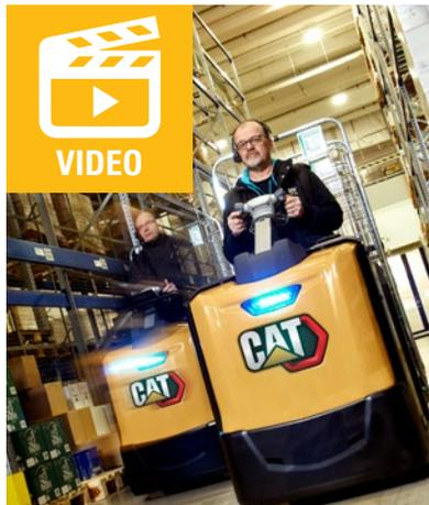
Die Kommissionierer bauen auf der Responsive Drive System (RDS) Technologie auf, welche bei neueren Cat Elektro-Gegengewichtstaplern eingeführt wurde. Sie reagieren schnell auf das Lenkverhalten des Fahrers und die Geschwindigkeit.
