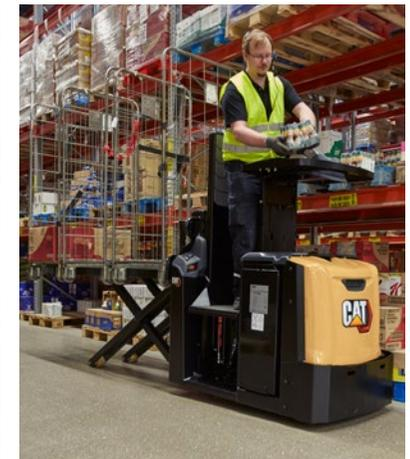
Der NO20N2X/N2XP kann zwei Europaletten oder drei Rollcontainer (optional 4 Rollcontainer auf 2850-mm-Gabeln) auf seinen Scherenhubgabeln transportieren. Die Hubgabeln heben den Ladeabschnitt auf 855 mm an, um eine ergonomische, einfache Warenentnahme zu ermöglichen und die körperliche Belastung zu reduzieren.
