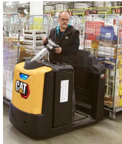
Die einzigartige intelligente Kurvenkontrollfunktion passt die Empfindlichkeit der Lenkung, die Kurvengeschwindigkeit und die Begrenzung des Lenkwinkels ständig wechselnden Anforderungen an. Die neueste Generation von Steuerungen und Software optimiert außerdem Beschleunigung, Traktion, regeneratives Bremsen und andere Merkmale für gleichmäßiges, sicheres, zuverlässiges und angenehmes Fahren.
