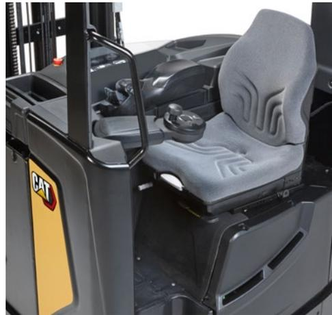
Die geräumige Kabine ist mit einem äußerst komfortablen Grammer-Sitz, verkleideten Wänden und praktischen Aufbewahrungsmöglichkeiten ausgestattet. Die moderne Fingertip-Hydrauliksteuerung ist in eine ergonomische, verstellbare Armlehne integriert. Der Fahrer kann das verstellbare Lenkrad aus einer Vielzahl von Handpositionen bedienen.
