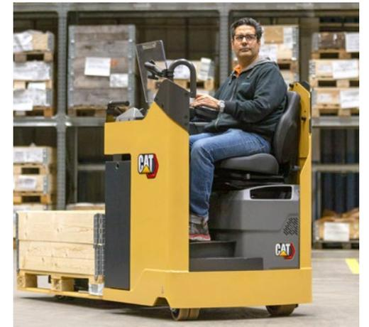
Eine ruhige, vibrationsarme und ergonomische Kabine minimiert die Belastung und Ermüdung des Bedienpersonals. Sie wurde für anhaltenden Komfort konstruiert und bietet neben einem leichten Ein- und Ausstieg viel Platz und einen Sitz mit einstellbarer Federung. Zu den optional verfügbaren zusätzlichen Komfortfunktionen gehört ein elektrisch höhenverstellbarer Boden zur perfekten Anpassung an jede Körpergröße.
