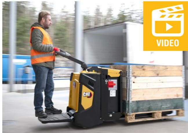
Der NPP20N3R ist mit einer zusammenklappbaren Plattform für den gelegentlichen Einsatz über längere Distanzen ausgestattet. Die geräumige gefederte Plattform des NPP20N3R für komfortables Fahren lässt sich problemlos besteigen und verlassen und bietet ausreichende Bodenfreiheit.
