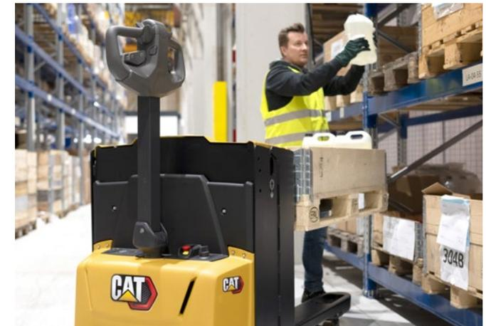
Der NPP20N3E verfügt über Hubgabeln (730 mm Höhe), die eine ergonomische Position für den Umschlag von Gegenständen mit minimaler körperlicher Anstrengung bieten.
