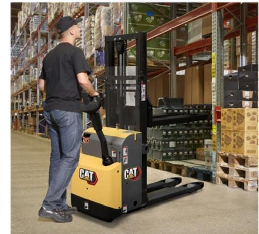
Ein neuer kompakter Deichsel-Palettenhubwagen, der NSP12N2C mit 1,2 Tonnen, ist jetzt verfügbar. Dieses leistungsstarke aber dennoch platzsparende Modell ist ideal für das Auffüllen von Lagerregalen, zum Stapeln, Kommissionieren und für kurze interne Transporte, zum Beispiel in Lagern, Supermärkten und Produktionsbereichen.
