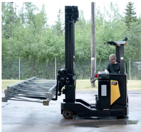
Les modèles multidirectionnels bénéficient du système *Responsive Drive System (RDS)*. En réaction à la vitesse de la pédale d'accélérateur et au mouvement de commande hydraulique, le système RDS adapte en continu le rapport paramètres de performance/besoins. Les mouvements du mât gagnent en rapidité, régularité, précision et contrôle, tandis que la stabilité est accrue et le balancement réduit.
