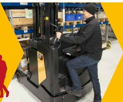
La gamme N2 est parfaite pour les entrées/sorties fréquentes grâce à sa marche abaissée et la faible hauteur du siège. En outre, son unité de direction peut être relevée pour faciliter l'entrée/la sortie de l'habitacle, puis ramenée à la position voulue. Elle offre également des niveaux supérieurs d'ergonomie et de confort.
