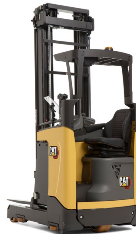
NR14N3C afgebeeld met taps toelopen beschermkooi en rail geleiding, beide optioneel
