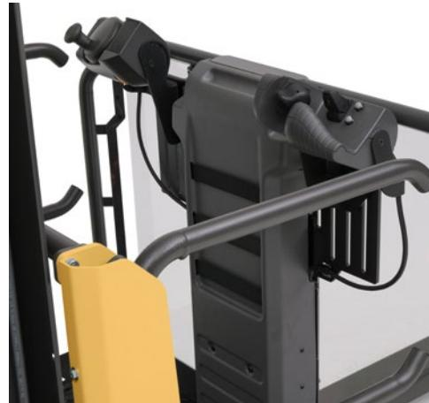
Napredno, korisnički prilagođeno sučelje sadrži uređaj za kontrolu s desnom rukom koji osigurava odlično anatomske prijanjanje, podešavanje položaja, hват и подршку, с ciljem udobnog i preciznog rada. Istovremeno, lijeva ruka stoji čvrsto na Midi kolu upravljača.
