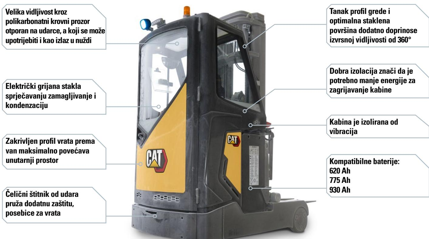
Ako je opremljen s kabinom i potrebnim preinakama za hladnjaču (MODCS), viličar može pouzdano raditi i pri vrlo niskim temperaturama do čak -35°C.
