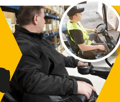
Komande i zasloni na modelima iz assortimenta N2 vrlo su slični onima na protutežnim viličarima marke Cat. Imaju klasični upravljač i ručnu hidrauličku upravljačku jedinicu montiranu na naslonu za ruku. Ovaj klasični i poznati raspored važan je ako vozač ujedno upravlja protutežnim viličarima.
