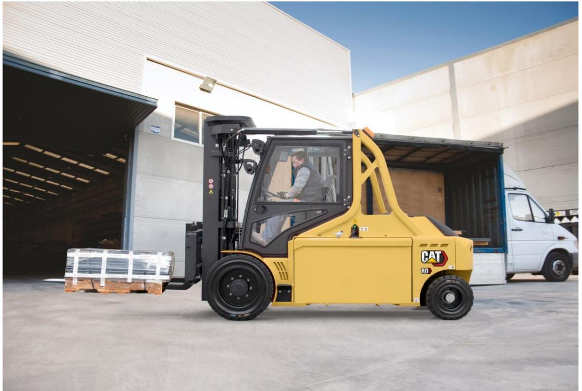
El espacioso compartimiento del operario de las Cat® EP60-120N(H) está montado sobre soportes de caucho para minimizar las vibraciones y el ruido.
