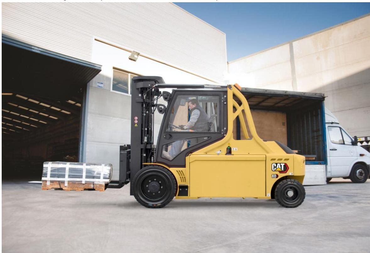
Le poste de travail spacieux de l'EP60-120N(H) Cat® est monté sur caoutchouc pour minimiser les vibrations et le bruit.
