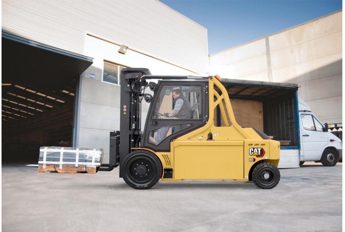
L'ampio vano operatore del Cat® EP60-120N(H) è rivestito in gomma per ridurre al minimo le vibrazioni e il rumore.
