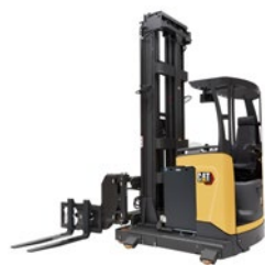
Hochregal-Schmalgangstapler: 1,3 – 1,5 Tonnen Tragkraft
