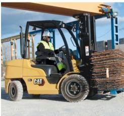
La gran variedad de opciones permite configurar la carretilla elevadora Cat para adaptarla exactamente a su aplicación. El doble filtro de aire, por ejemplo, aumenta la protección del motor en aplicaciones con gran cantidad de polvo, como en aserraderos y fábricas de ladrillos; además, es posible fijar argollas de izado opcionales, para elevar la carretilla y depositarla en barcos o camiones para tareas portuarias o móviles.
